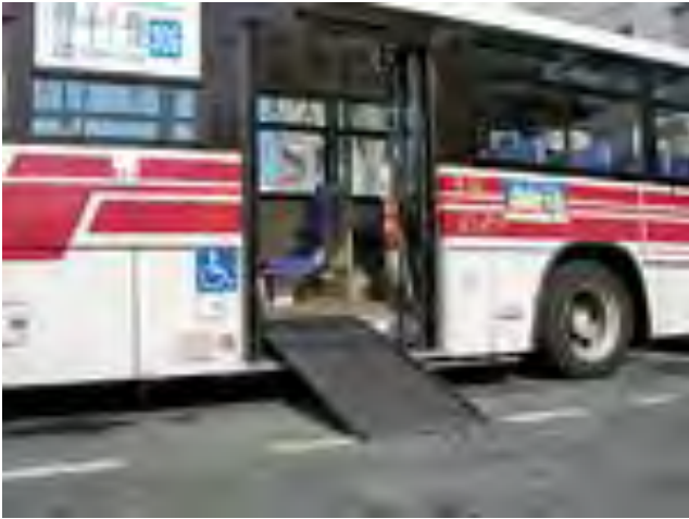
入口部に設置されたスロープ (車いす利用者のために)
